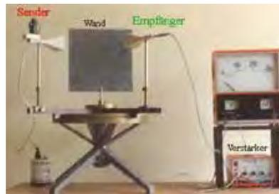
**B8** | Reflexion von Mikrowellen an einer Metallplatte.
