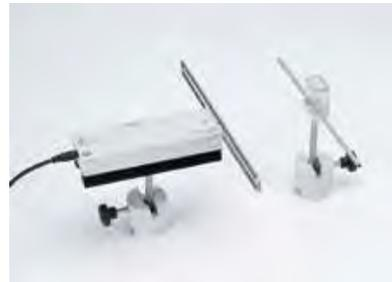
**B2** Dezimeterwellensender mit einer Empfangsantenne mit Glühlampe.
