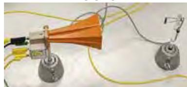
**B3** | Klystron zur Erzeugung von Mikrowellen mit Empfängsdipol.
