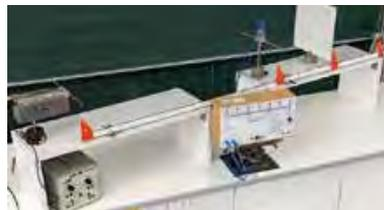
**B1** | Sender, Empfänger und Reflektor von Dipolstrahlung.
