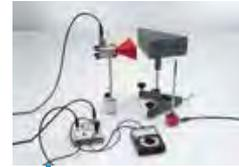
**B5** Brechung von Mikrowellen am Prisma. Der Empfängerdipol muss keinen Trichter tragen, wie in der Abbildung der Stab auf dem roten Sockel.
