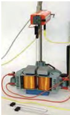
**B1** Die Stromwaage misst die Kraft  $F_{ma}$  auf das Leiterstück im homogenen Magnetfeld.
