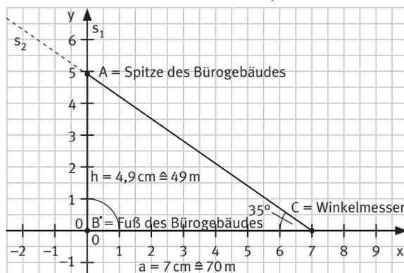
Die Konstruktion erfolgt nach WSW mit  $a = 7 \text{ cm}$ ,  $\beta = 90^\circ$  und  $\gamma = 35^\circ$ , sie ergibt eine Höhe von  $4,9 \text{ cm}$ . Das Bürogebäude ist demnach  $49 \text{ m}$  hoch.
