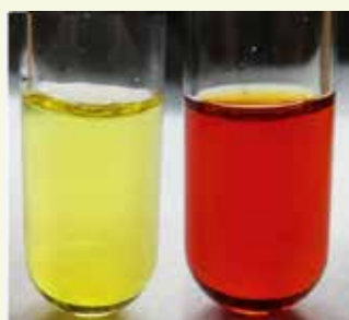
B1 Vergleichslösung (links) und Probelösung mit Alkohol (rechts), jeweils mit Cerammoniumnitratlösung
