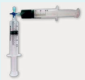
B1 Befüllen der Spritze mit Kohlenstoffdioxid
