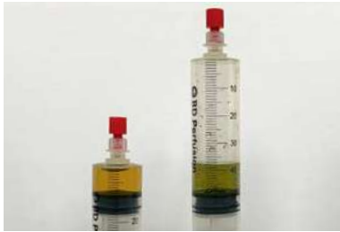
B4 Löslichkeit von Kohlenstoffdioxid in Wasser bei Normaldruck (links) und bei vermindertem Druck (rechts)
