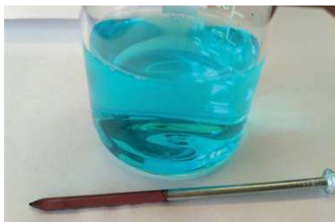
B5 Eisennagel nach dem Eintauchen in eine Kupfer(II)-sulfatlösung
