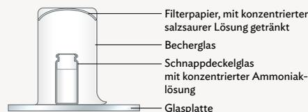
B4 Versuchsaufbau zu LV5
